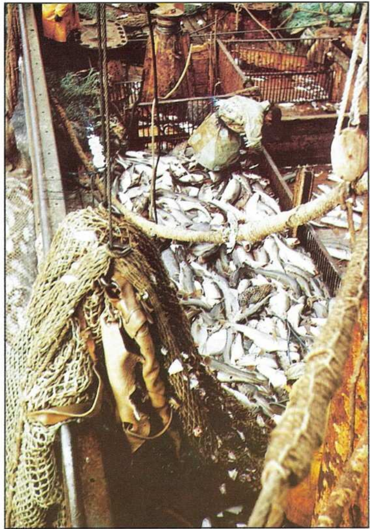
Les étapes de l'embarquement d'une palanquée : En haut à gauche (1), celle-ci monte le long du bord. L'étrangleur qui reste en permanence sur le chalut est relié avec un filin à la corde de dos. En haut à droite (2), la palanquée est embarquée, un marin va larguer le cul. En bas (3), la palanquée est déversée sur le pont. Photographie André Tonnerre.
