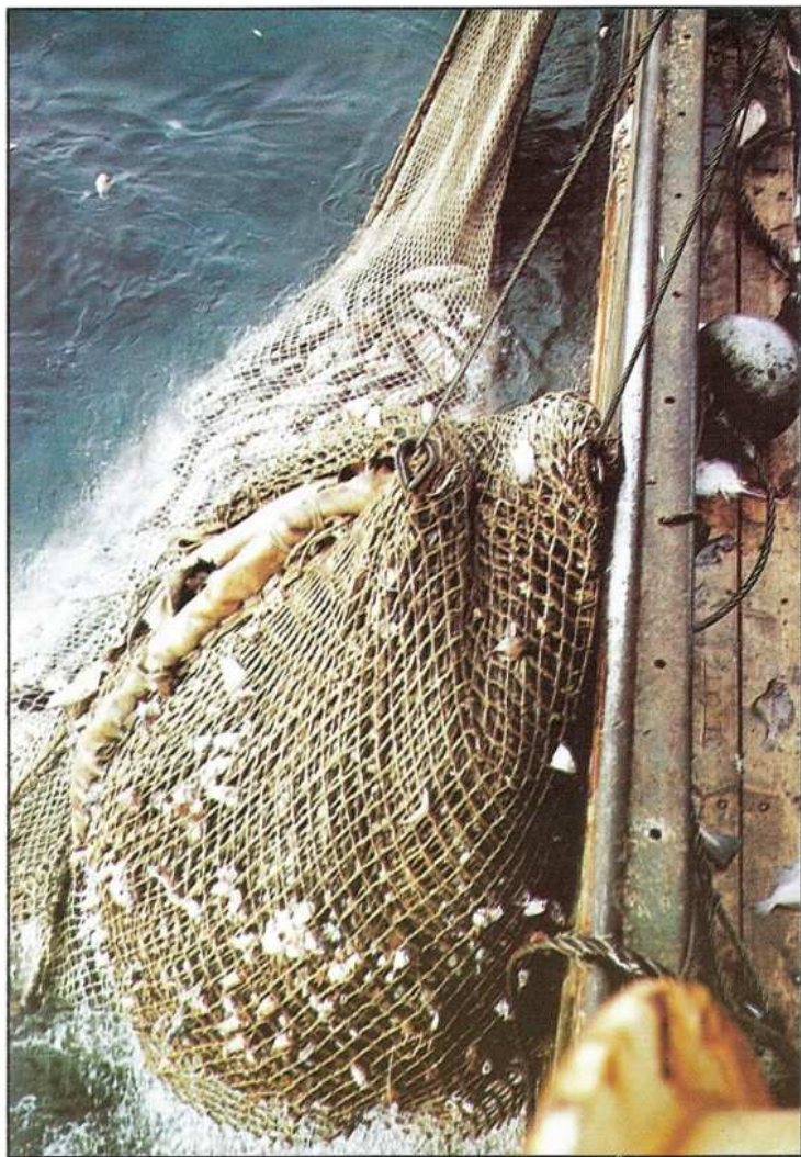
Les étapes de l'embarquement d'une palanquée : En haut à gauche (1), celle-ci monte le long du bord. L'étrangleur qui reste en permanence sur le chalut est relié avec un filin à la corde de dos. En haut à droite (2), la palanquée est embarquée, un marin va larguer le cul. En bas (3), la palanquée est déversée sur le pont. Photographie André Tonnerre.
